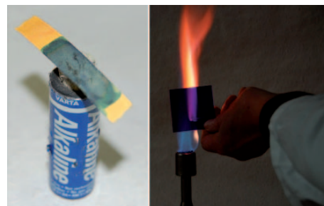
Abb. 4: Prüfung der äußeren Probe a) mit Indikatorpapier (links), b) mit der Flammenfärbung
